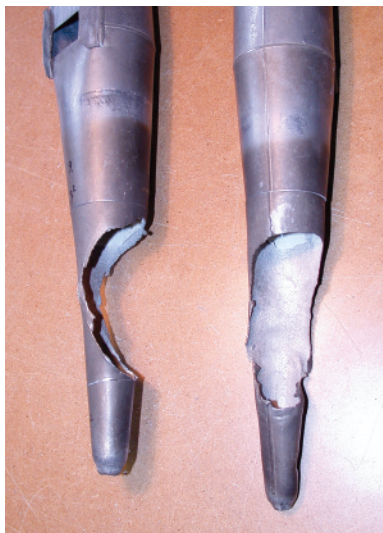
Caños del bourdon 8 antes de su reparación
